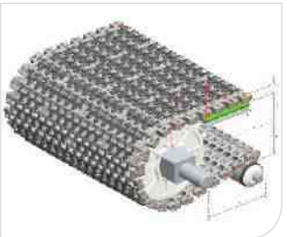
Type 型号：HS-500EL Pitch 节距：25MM Thickness 厚度：15.5MM Open area 开孔率：36%
