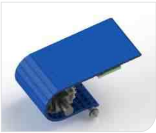
Type 型号 : HS-4800D Pitch 节距 : 25.4MM Thickness 厚度 : 13.3MM Open area 开孔率 : 0%
