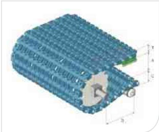
Type 型号 : HS-1700B Pitch 节距 : 38.1MM Thickness 厚度 : 18.9MM Open area 开孔率 : 37%
