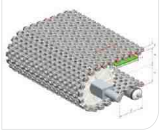
Type 型号：HS-501D Pitch 节距：25.4MM Thickness 厚度：15.5MM Open area 开孔率：35%
